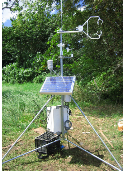
Figure 7 : Disposition des capteurs sur le trépied de 3m
