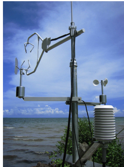
Figure 7 : Disposition des capteurs sur le trépied de 3m
